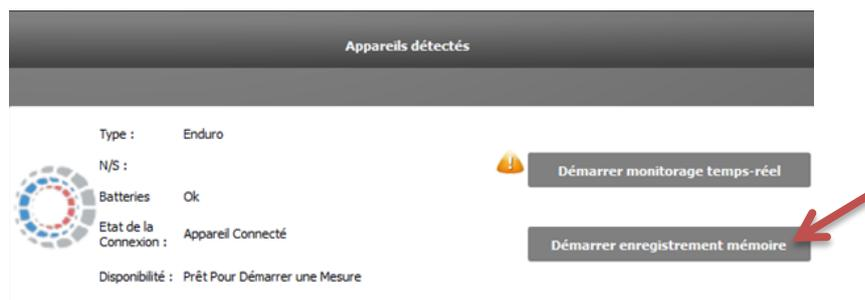
L'enregistrement en mémoire interne de l'appareil ne débute que lorsque la phase de monitoring est active. Avant, la procédure décrite dans le chapitre « [Démarrer une mesure](#) » reste applicable.
